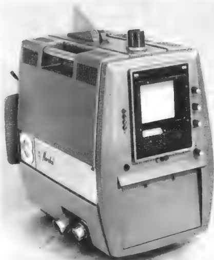
Bild 6. Rückansicht der Kamera ohne Suchertubus und ohne Objektiv. Oben die große, nach vorn abgeschirmte Signallampe und davor das ein- und ausschwenkbare Warnzeichen, das den vom Vario-Objektiv bestrichenen Bildwinkel anzeigt
