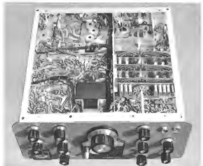
Bild 11. Blick unter das Chassis: Rechts Hf-Teil mit Bandschalter (Abdeckblech entfernt), links vorn das Quarzfilter
