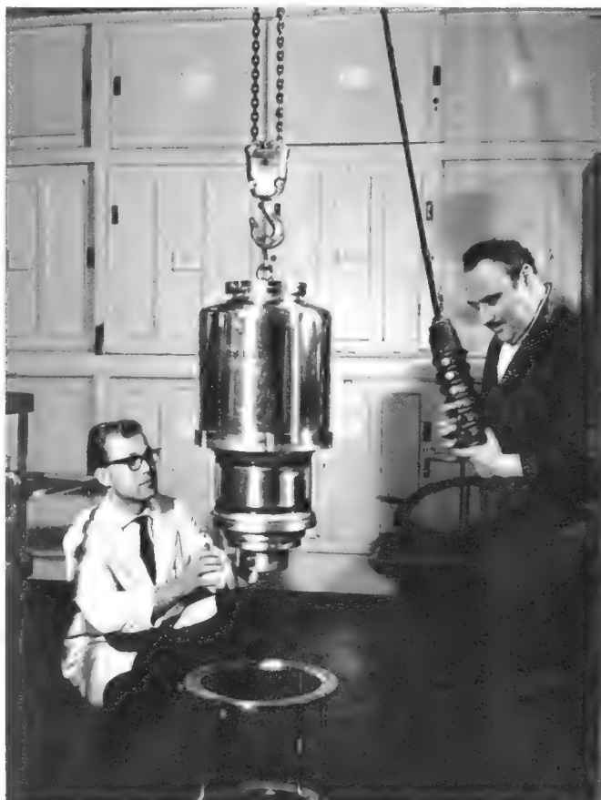
Bild 1. Siedegekühlte 500-kW-Senderöhre Rs 1828
