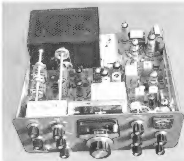
Bild 10. Chassisansicht des SB 100. Links hinten in der Abschirmung ist die Sender-Endstufe untergebracht
