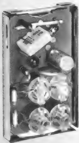
Links: Bild 1. Geöffnetes Modul (AM/FM-Zf-Verstärker). Die Anschlußstifte liegen auf der Rückseite
