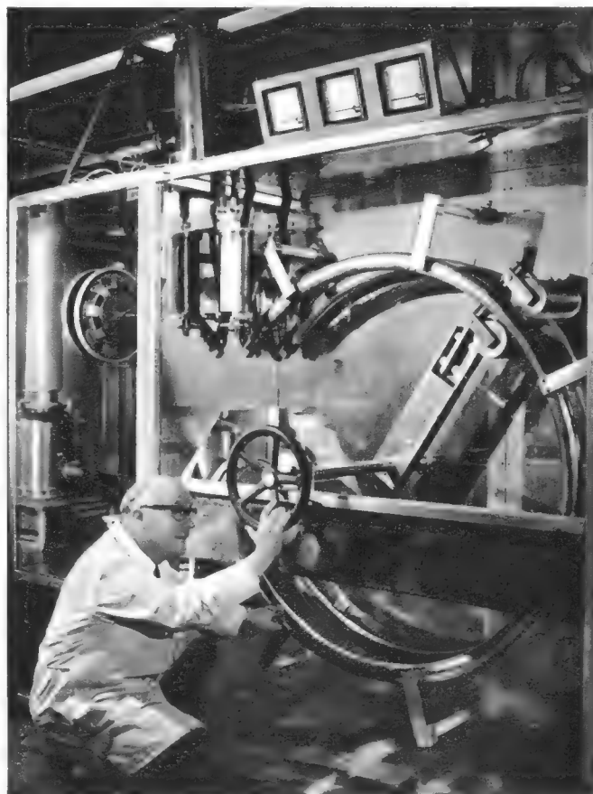
Bild 2. Variometer im Anodenkreis der Leistungs-Endstufe Hf 6
