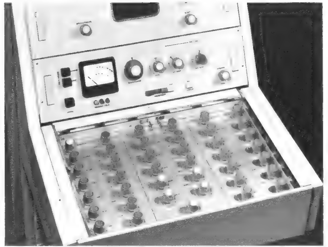
Bild 7. Bedienungsfläche des Kontrollgestells bei ins Innere zurückgeschobener Deckplatte
